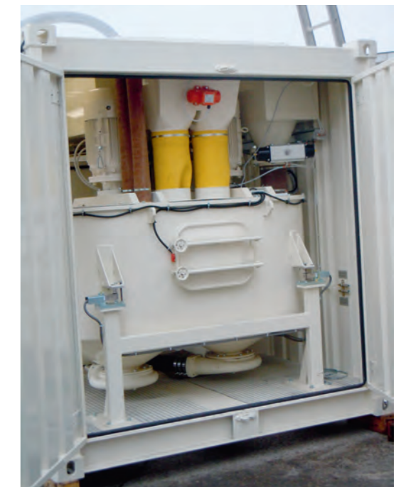
Mixer: Doppia pompa a girante aperta e porta d'ispezione Mixer: Double open impeller pump and inspection door
