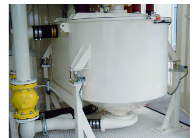
Sistema di pesatura a celle di carico Load cells weighing system
