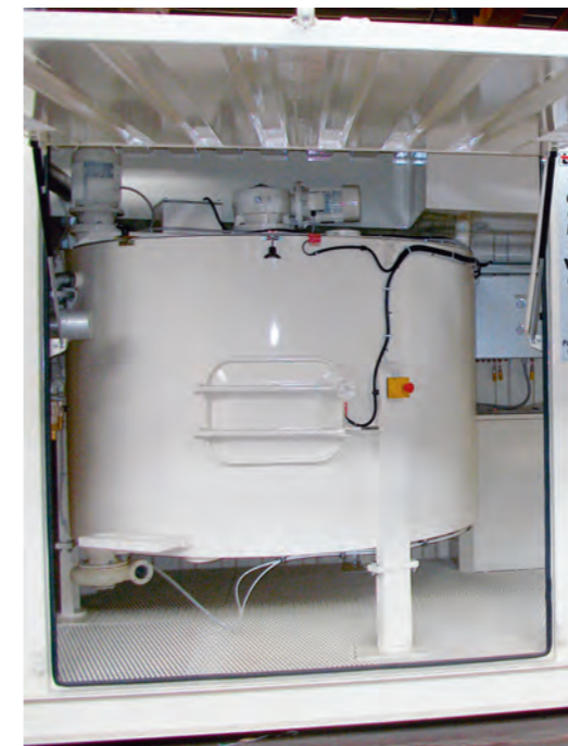
Agitatore: Pompa di sovralimentazione e porta d'ispezione Agitator: Booster pump and inspection door
